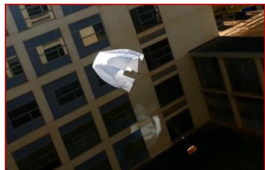
Fig. 13. Ensayo del sistema de recuperación de un cohete
