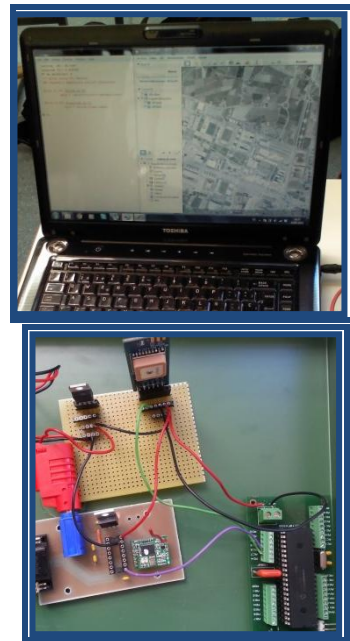
Fig. 16. Diseño del sistema de posicionamiento mediante GPS
