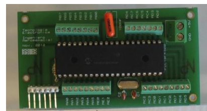
Fig 3. PCB de diseño propio con el PIC18F4520
