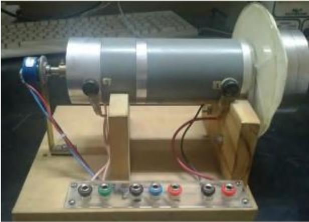
Fig. 2. Sistema motor-volante-sensor de posición
