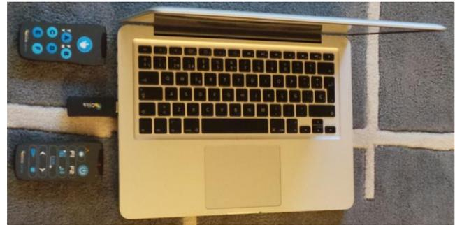
Fig. 1. Componentes del sistema de votación interactivo con los mandos del profesor (izquierda, abajo) y alumnos (izquierda, arriba).
